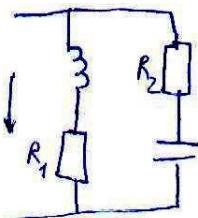
$$\omega_0 = \frac{1}{\sqrt{LC}} \sqrt{\frac{L}{C} - R_1^2} \quad \text{a)} \frac{L}{C} > R_1^2, \frac{L}{C} > R_2^2 \left( \frac{L}{C} < R_1^2, \frac{L}{C} < R_2^2 \right) - \text{рез. существует.}$$
