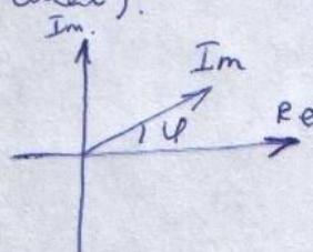
$$I_m = I_m e^{j\varphi} = I_m (\cos \varphi + j \sin \varphi) - \text{комплекс амплит. знач.}$$
