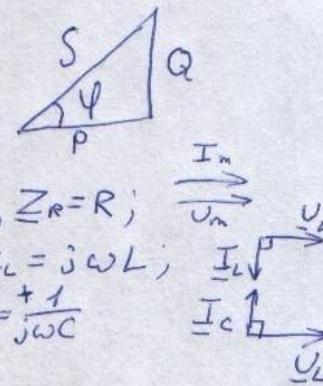
Резистор:  $V(t) = U_m \sin \omega t$ ,  $i(t) = I_m \sin \omega t$ ;  $U_m = R I_m$ ;  $Z_R = R$ ;
